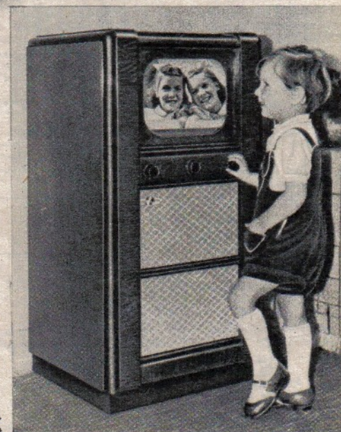
Weltfunk-Fernsehempfänger „Aladin“ (Krefft AG). Das Gerät ist fest auf einen Kanal abgestimmt
