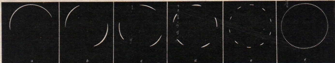
Abb. 1. Oszillogramme zur Frequenzmessung durch Hellsteuerung eines Kreisbildes
